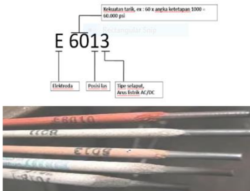
Gb 2. Spesifikasi elektroda Sumber: Rahman and Dwi Rahdiyanta (2022)
